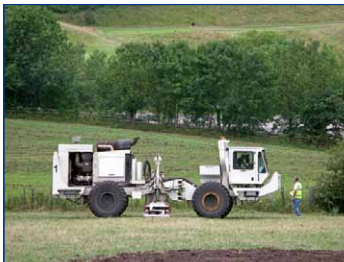
Camión especializado usado en el estudio sísmico llevado a cabo por Sonorex
